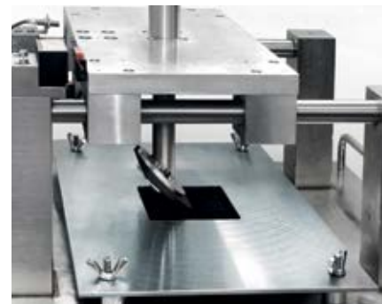
Zariadenie na vykonávanie podpätkového testu. Skúšanie pevnosti upevňovacích prvkov.
