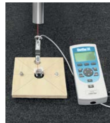
Prístroj na vykonávanie podpätkového testu Testovanie pevnosti fixačných elementov
