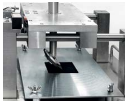
Prístroj na vykonávanie podpätkového testu Testovanie pevnosti fixačných elementov
