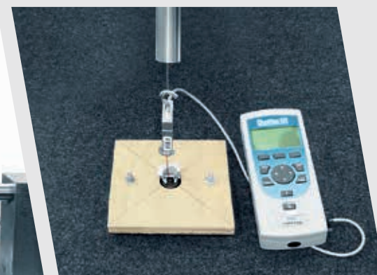
Testovanie pevnosti fixačných elementov
