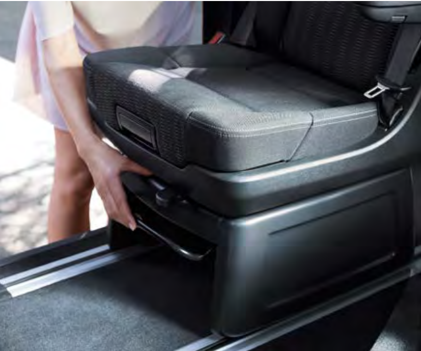
Inteligentný koľajničkový systém s otočnými sedadlami pre neobmedzenú flexibilitu.
