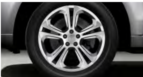
Hliníkové liate disky Audi exclusive s 5-dvojlúčovým Offroad dizajnom, rozmery 8,5 J x 20 s pneumatikami 255/45 R 20, vrátane lemovania blatníkov. Ponuka od quattro GmbH
