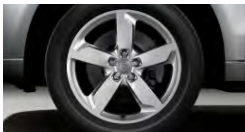
Hliníkové liate disky s 5-ramenným dizajnom, čiastočne leštené, rozmery 8 J x 19 s pneumatikami 235/55 R 19
