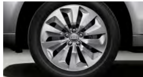
Hliníkové liate disky s 10-ramenným turbínovým dizajnom (hybridný dizajn), rozmery 8 J x 19 s pneumatikami 235/55 R 19
