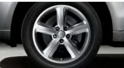
Hliníkové liate disky Audi exclusive s 5-lúčovým dizajnom, rozmery 8 J x 19 s pneumatikami 235/55 R 19. Ponuka od quattro GmbH
