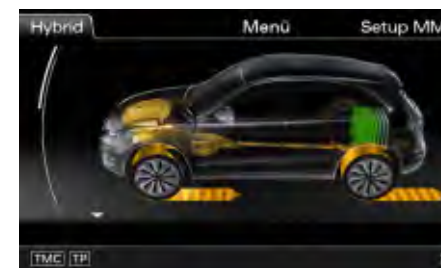
kombinovaná jazda v hybridnom režime so spaľovacím motorom a elektromotorom
