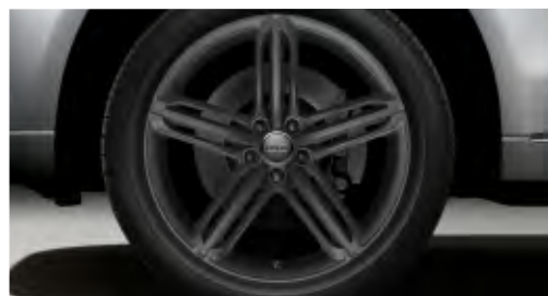
Hliníkové liate disky Audi exclusive s 5-lúčovým segmentovým dizajnom, titánová optika, rozmery 8,5 J x 20 s pneumatikami 255/45 R 20, vrátane lemovania blatníkov. Ponuka od quattro GmbH
