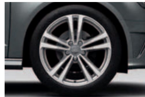
Hliníkové liate disky s 5-lúčovým paralelným dizajnom, čiastočne leštené
