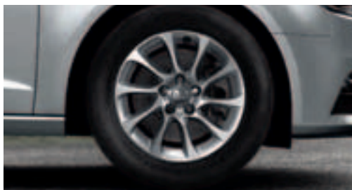
Hliníkové liate disky s 10-lúčovým dizajnom, rozmer 6,5 J x 16 s pneumatikami 205/55 R 16
