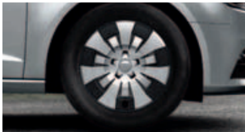
Oceľové disky vrátane celoplošných krytov, rozmer 6,5 J x 16 s pneumatikami 205/55 R 16
