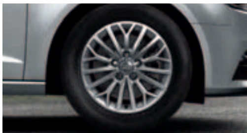
Hliníkové liate disky s 15-lúčovým Y-dizajnom, rozmer 7 J x 16 s pneumatikami 205/55 R 16
