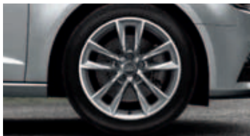
Hliníkové liate disky s 5-ramenným kinetickým dizajnom, rozmer 7,5 J x 17 s pneumatikami 225/45 R 17 (voliteľné s pneumatikami s núdzovým dojazdom)
