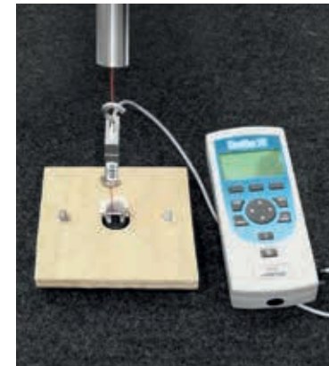
Zariadenie na vykonávanie podpätkového testu. Skúšanie pevnosti upevňovacích prvkov.
