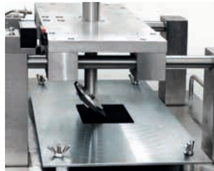
Zariadenie na vykonávanie podpätkového testu. Skúšanie pevnosti upevňovacích prvkov.
