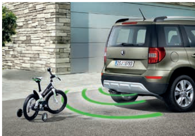
Zadné parkovacie senzory na monitorovanie vzdialenosti potenciálnych prekážok od vozidla. Ak sa vo vzdialenosti 140 cm od zadnej časti vozidla objaví prekážka, je signalizovaná krátkymi pípnutiami v intervale 1 sekundy. Tento interval sa s približovaním k prekážke plynule skracuje. Pri priblížení vozidla na 30 cm prejde pípanie do nepretržitého tónu (BEA 630 001) Cena: 230,58€
